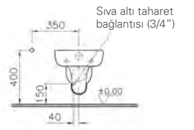
Sıva altı bağlantı
