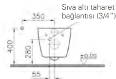
Sıva altı bağlantı
