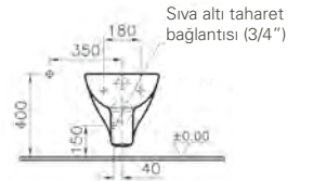
Sıva altı bağlantı
