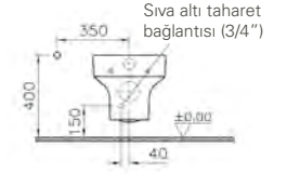
Sıva altı bağlantı
