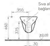
Sıva altı bağlantı
