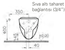
Sıva altı bağlantı
