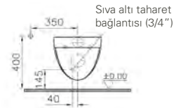
Sıva altı bağlantı
